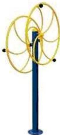
O aparelho deverá ser resistente a ações climáticas, isento de estofamento e de baixa manutenção, produto que possibilite uma sensação de liberdade ao usuário com ótima biomecânica, Estrutura principal em tubo redondo de 127mm de diâmetro na chapa 14, estrutura secundária em tubo redondo 02" na chapa 14 dobrados com perda mínima de perfil, tubos cortados a laser, base em ferro trefilado para montagem do equipamento, chapas dobradas as frio
