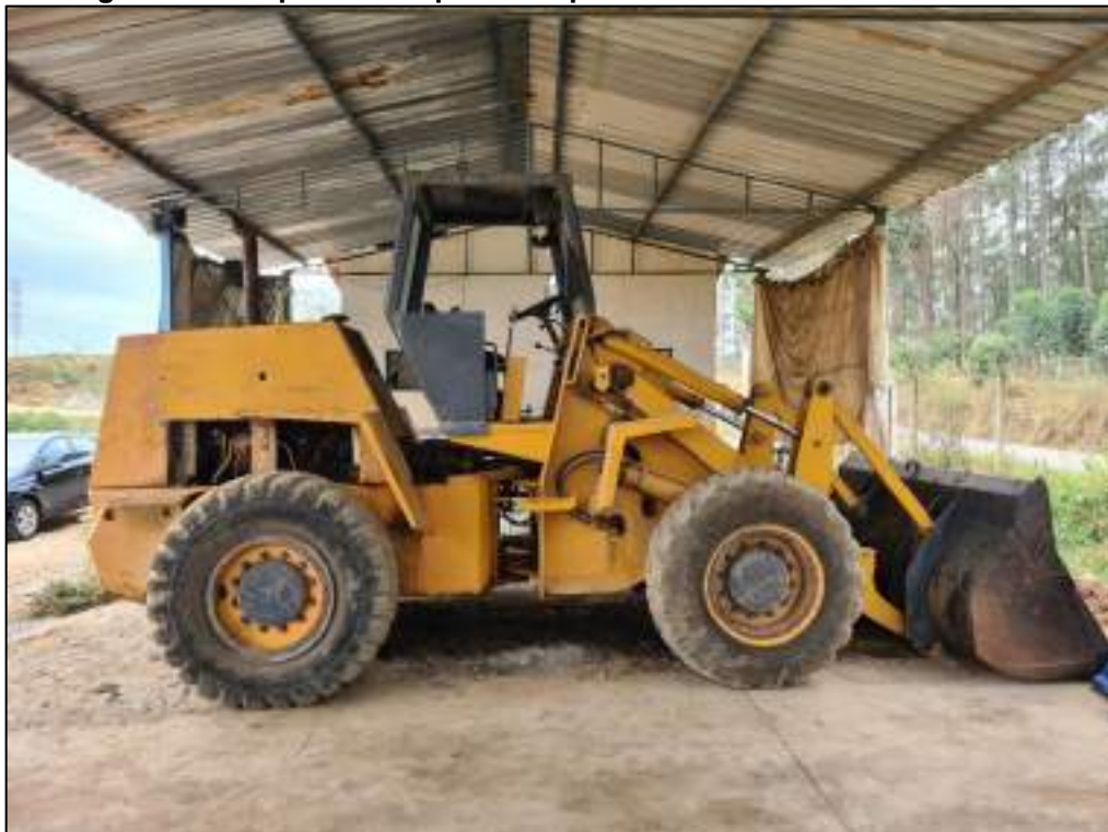
Figura 42 - Maquinário responsável pelo Assentamento dos Resíduos.
