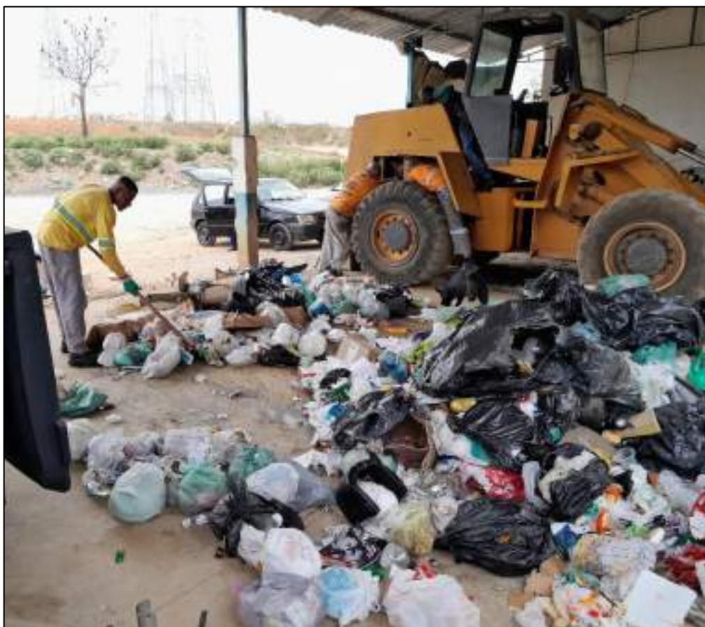
Figura 12 - Abertura dos sacos plásticos sobre o piso impermeável.
